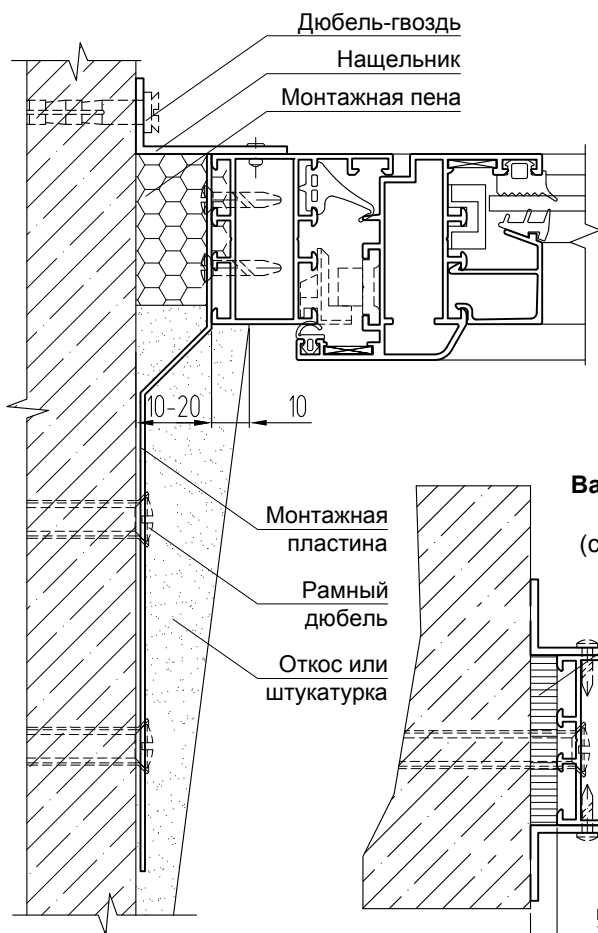
Вариант монтажа с помощью монтажных пластин
