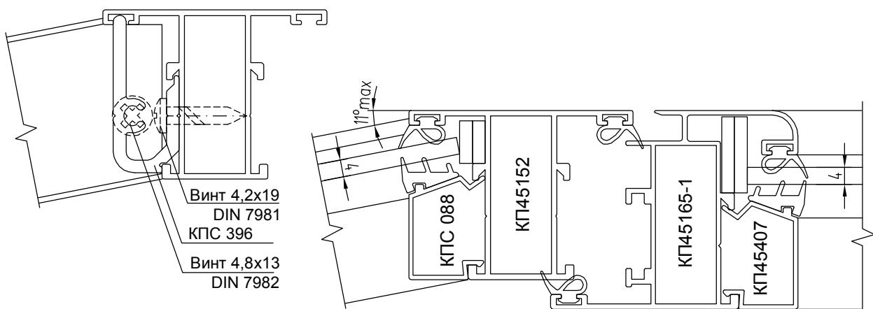
Узлы поворотов на произвольный угол
