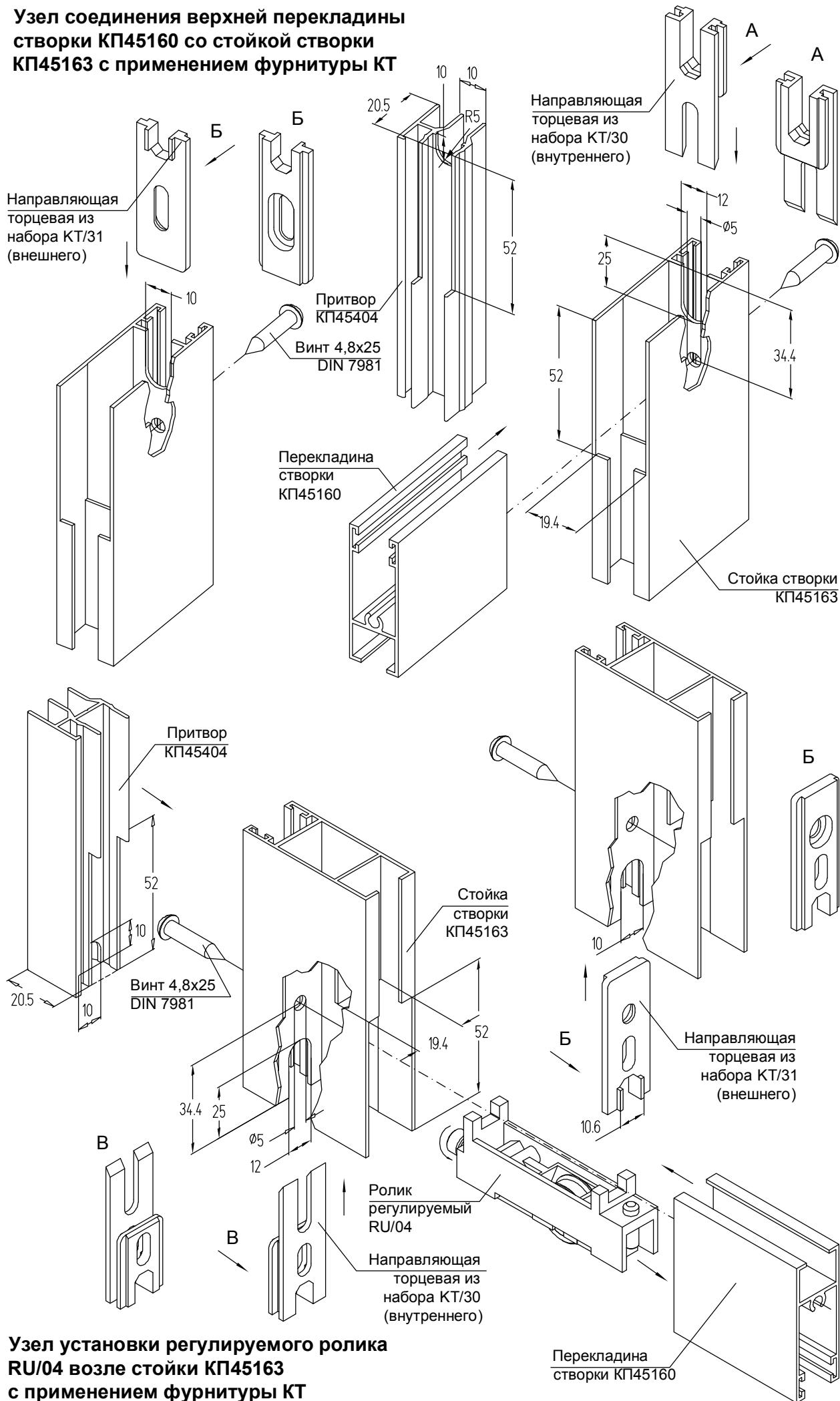
**Узел установки регулируемого ролика RU/04 возле стойки КП45163 с применением фурнитуры КТ**
