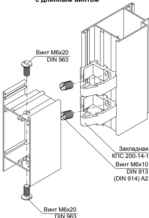
**Крепление широкого ригеля КПС 335-1 к стойке КПС 073 при помощи двух закладных КПС 200-14-1**
