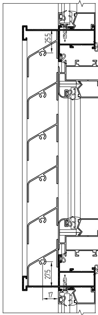
Установка в витраж КП40 вентиляционной решетки с рамой из профиля КПС 165
