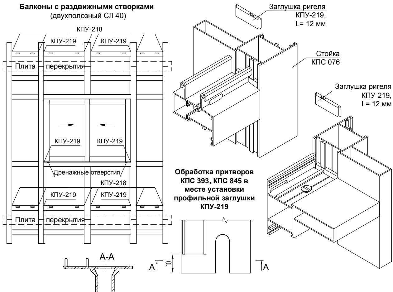
**Герметизация ригеля под раздвижными створками при помощи профильной заглушки КПУ-220** (двуухпозиционный СЛ40 на стойках с широким внешним пилоном )
