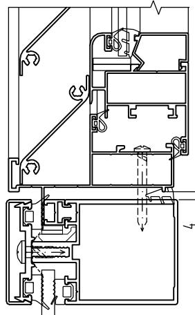
**Установка вентиляционной решетки в витраж КП40 при помощи ригелей КПС 1247 (горизонтальное сечение )**
