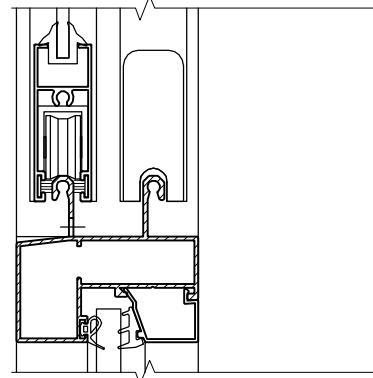
Выполнение дренажных отверстий в нижней направляющей КПС 816
