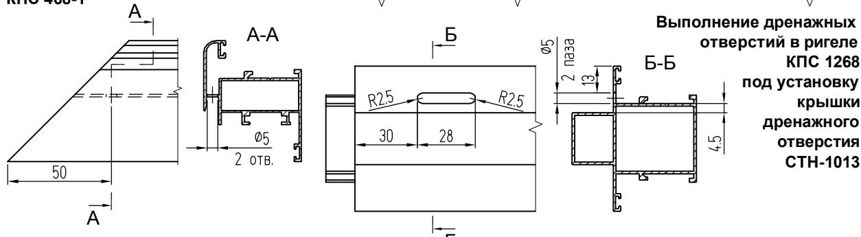
Выполнение дренажных отверстий в ригеле КПС 1268 под установку крышки дренажного отверстия СTH-1013
