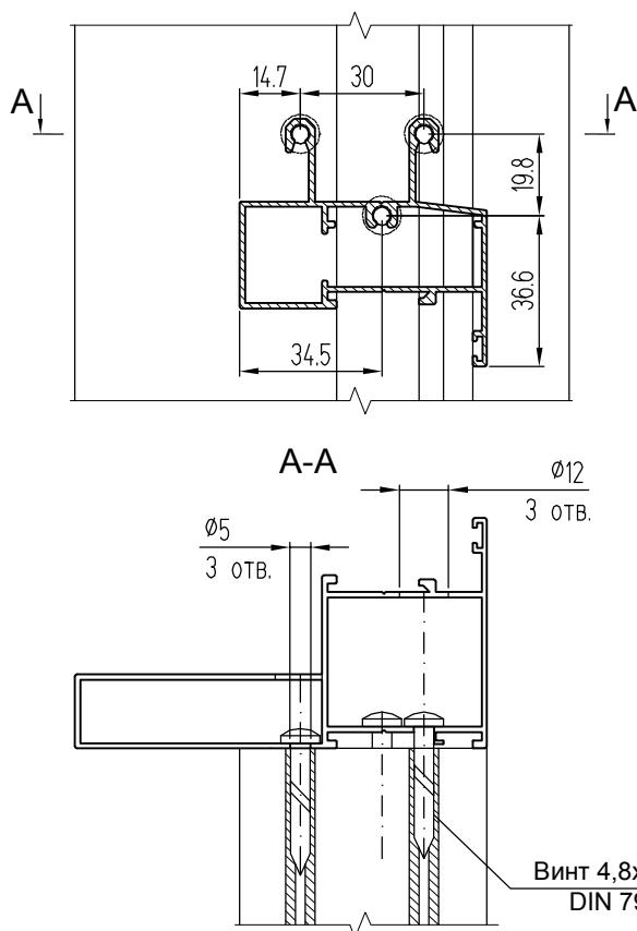
**Крепление цоколя КПС 250 к стойке створки двери КПС 083 при помощи двух закладных КПС 200-14-1 с длинным винтом**
