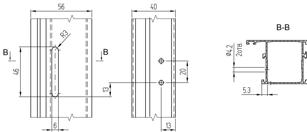
**Соединение притвора КПС 340 со стойкой полотна двери КПС 336 и нижней перекладиной КПС 250 со стороны "глухой" части раздвижной двери**
