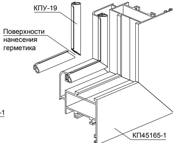
Подрезка уплотнителя притвора КПУ-19 под установку петли поворотной фурнитуры
