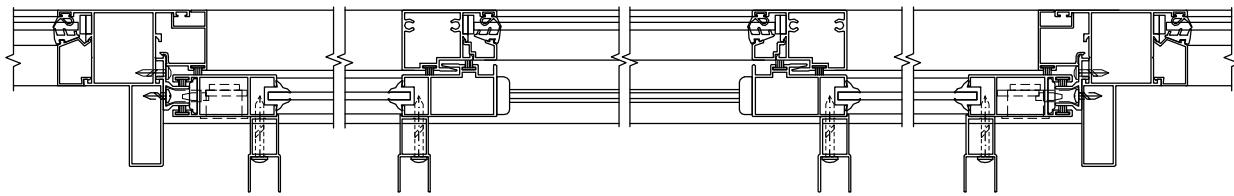
**Вариант с усилителем стойки створки КПС 651**
