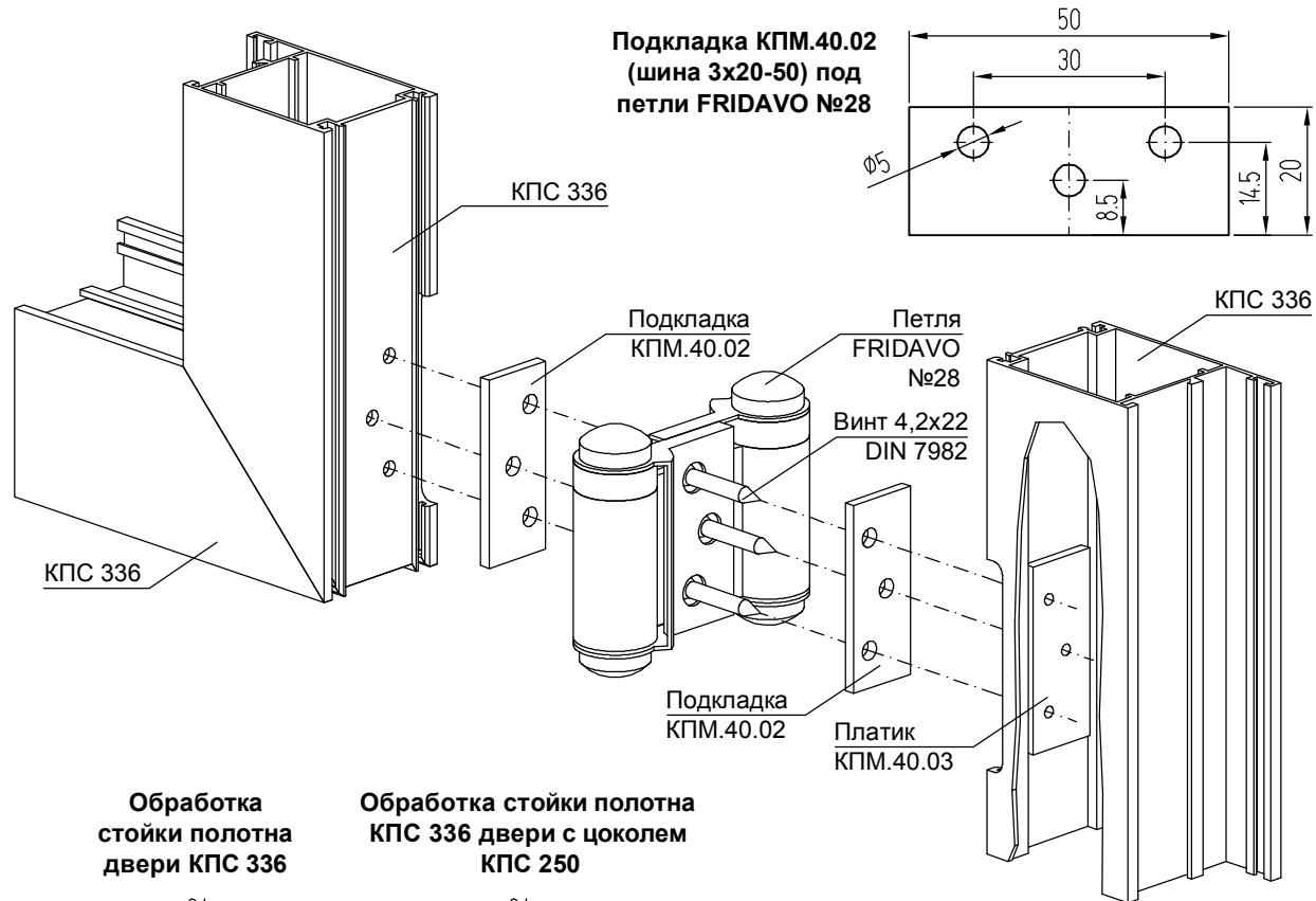
Обработка стойки полотна двери КПС 336
