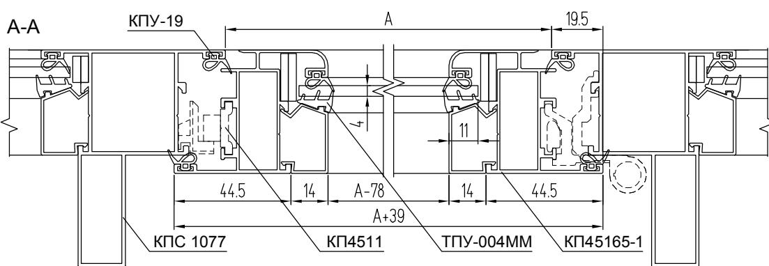
**Фрагмент балкона с одной распашной створкой с открыванием внутрь на стойках с широким внутренним пилоном (вид из помещения)**
