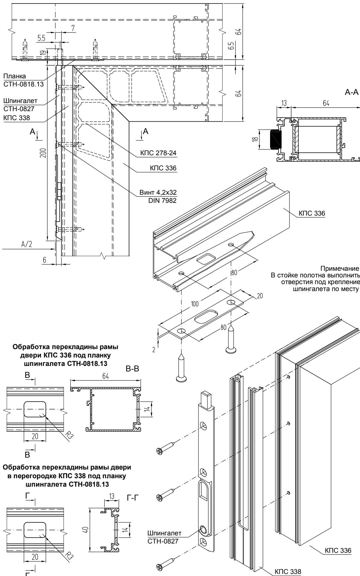
**Установка нижнего врезного шпингалета СТН-0827 в крышку стойки полотна мятниковой двери КПС 338**
