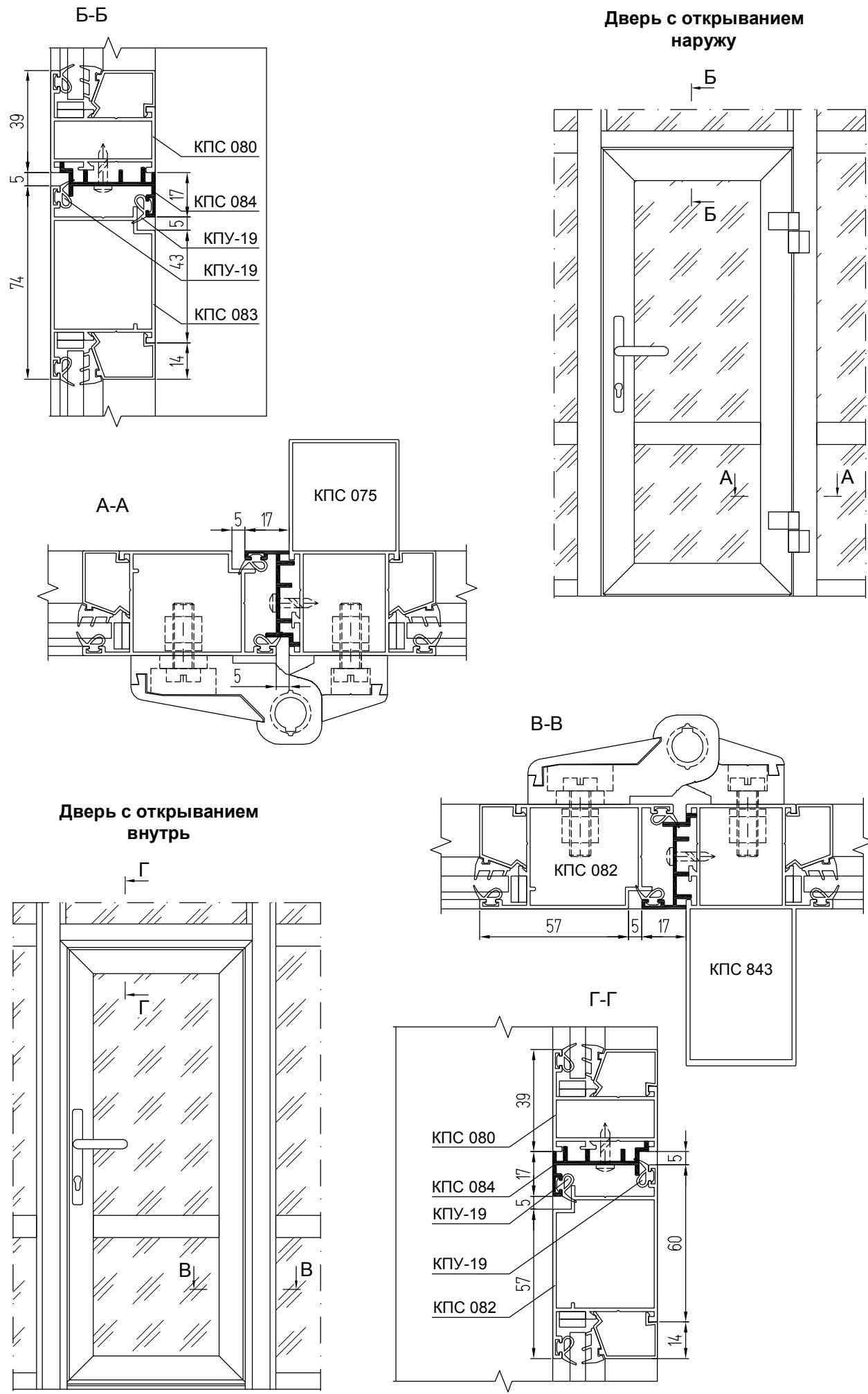
**Установка одностворчатых дверей из оконного профиля с
