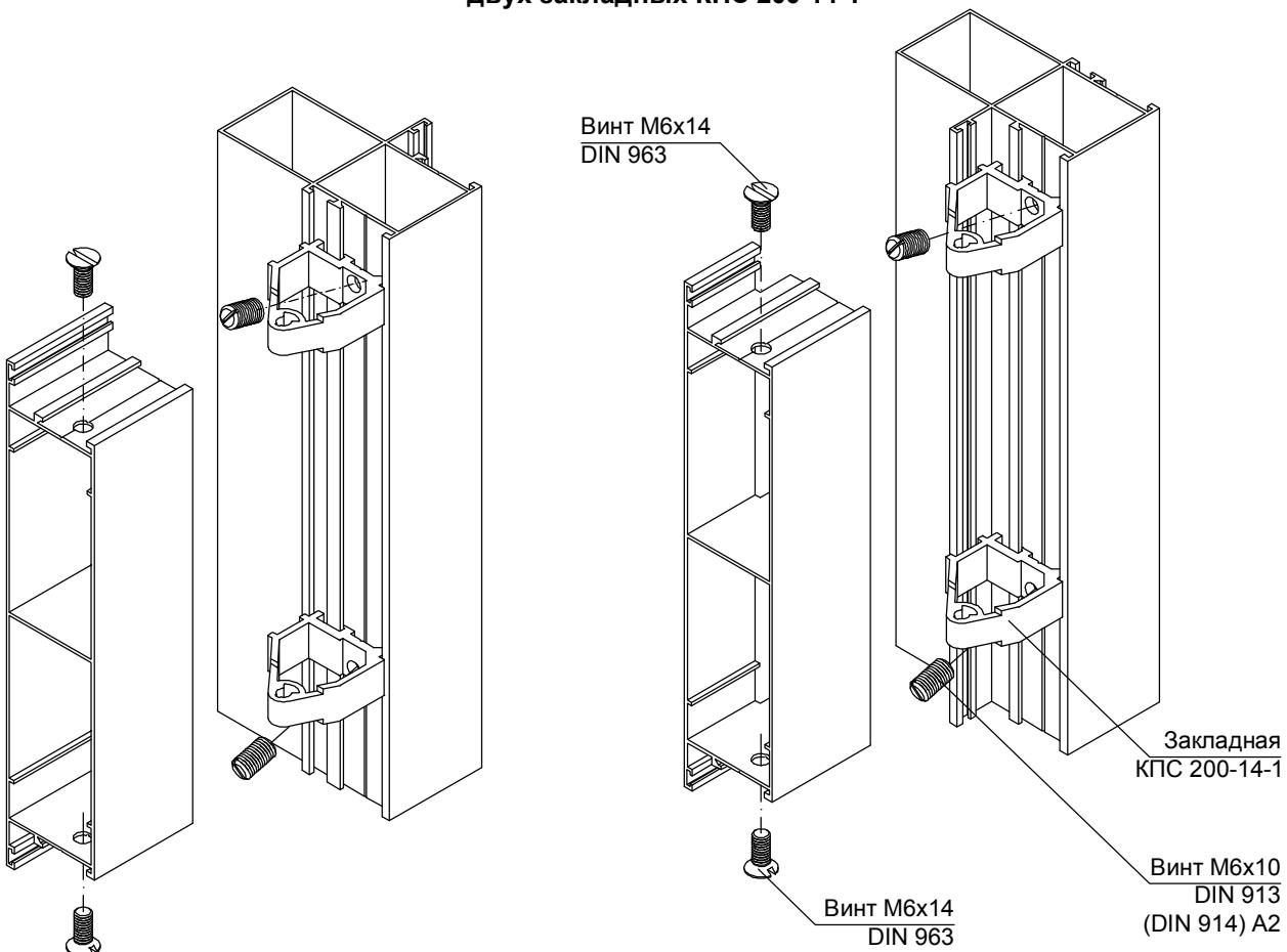
**Крепление ригеля вентиляционной решетки КПС 1247 к стойке КПС 844
