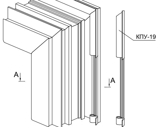
Подрезка уплотнителя притвора КПУ-19 под установку петли поворотно-откидной фурнитуры
