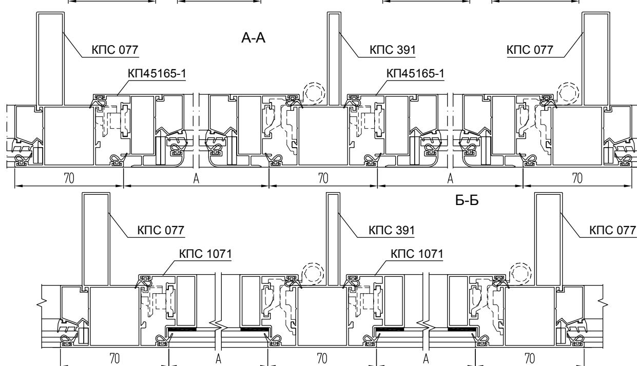
**Фрагмент балкона с одной распашной створкой с открыванием внутрь на стойках с широким внутренним пилоном (вид из помещения)**
