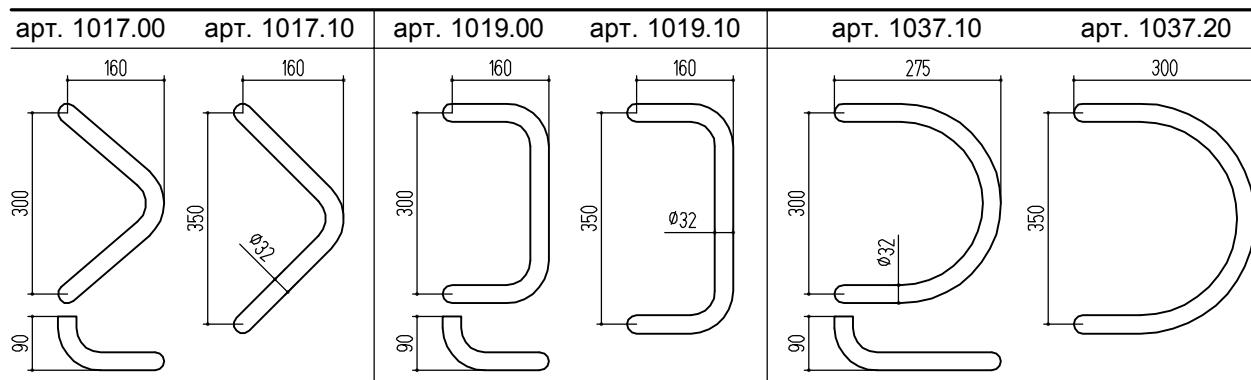
Примечание: L=28+D (мм), где L - длина шпильки, D - толщина профиля.
