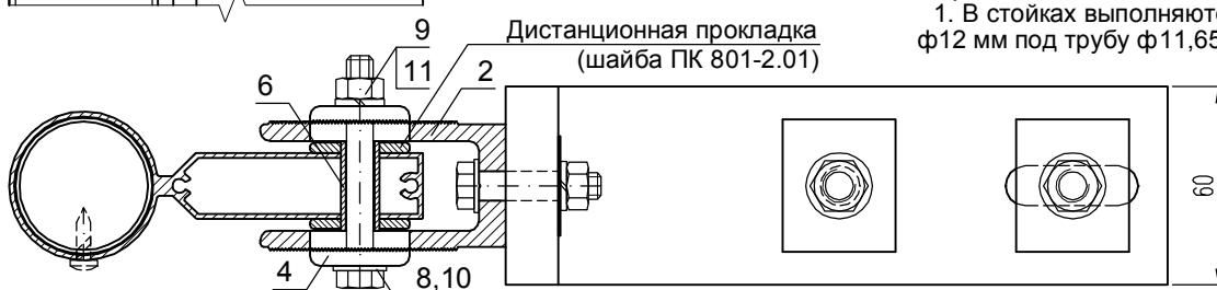
**Узел крепления стоек к плите перекрытия при помощи кронштейна Кр-986-985-60**
