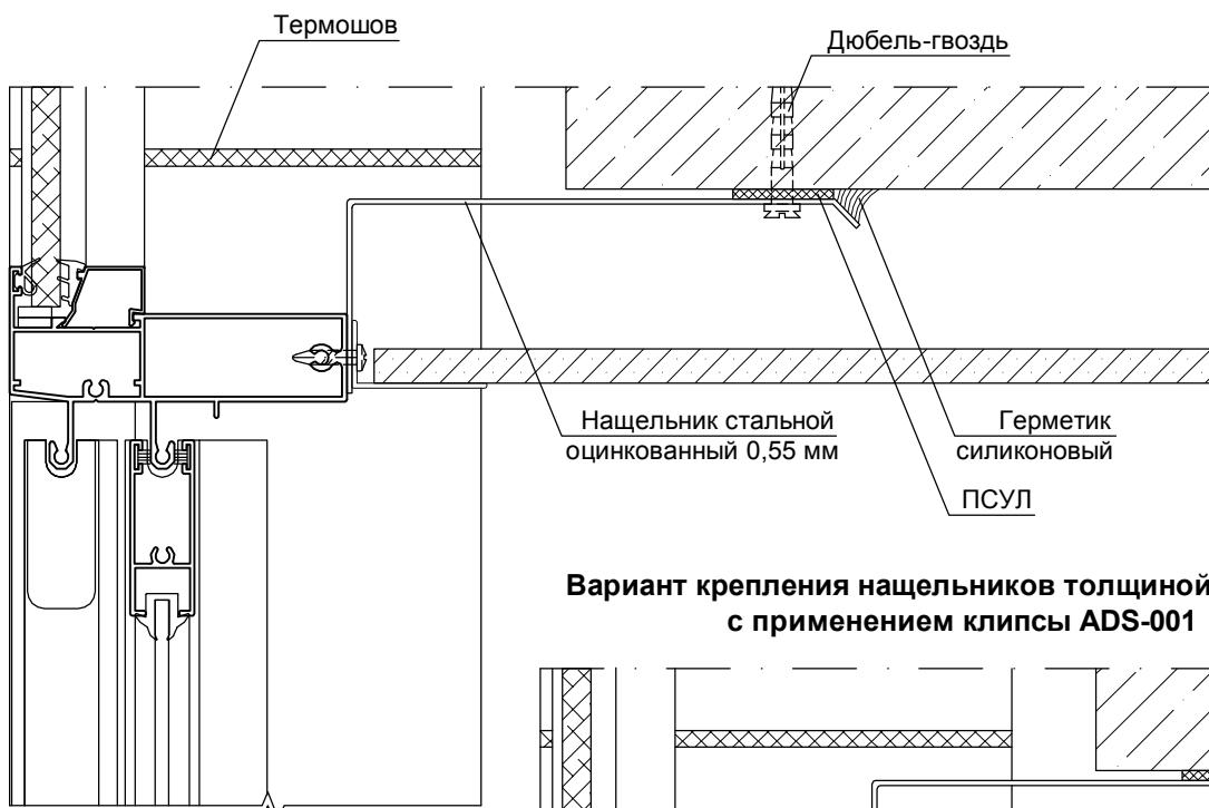
**Вариант крепления нащельников толщиной 0,5 - 2 мм
