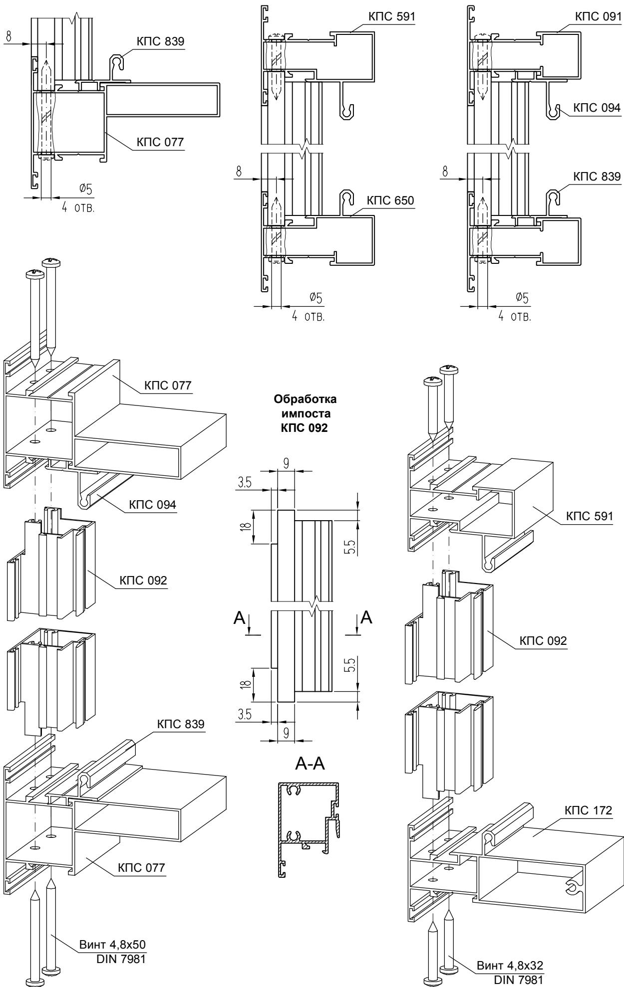
**Установка штапиков "глухой" части однополозного СЛ40**
