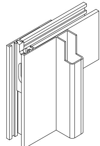
Обработка стойки КПС 471 с фрезеровкой
