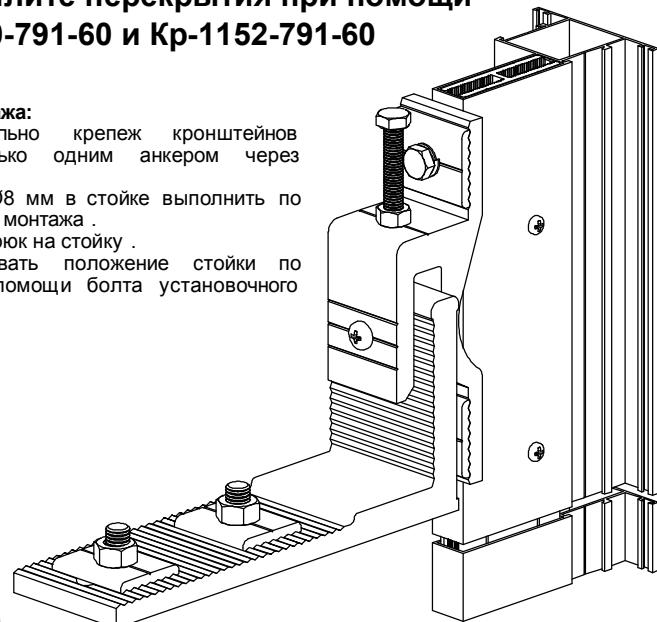
5. Отрегулировать положение стойки по горизонтали перемещением кронштейна вдоль продольного паза .
