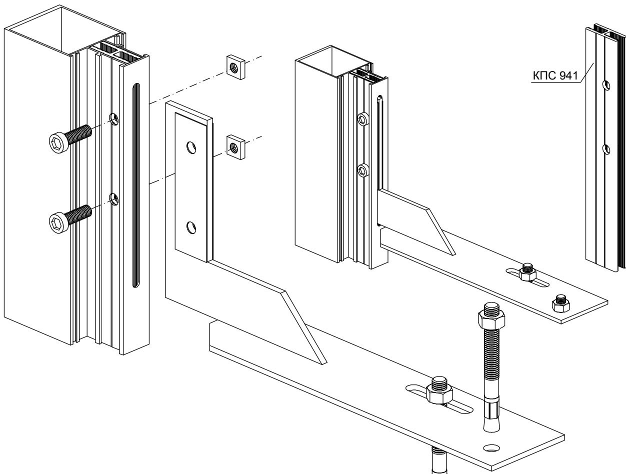
**Крепление стоек к плите перекрытия при помощи стального несущего кронштейна КСН-40-1 (на примере стойки КПС 1104)**
