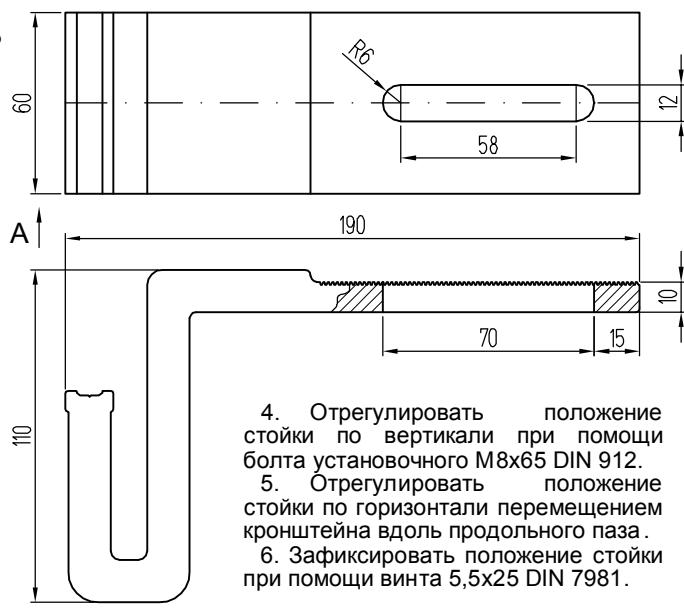
4. Отрегулировать положение стойки по вертикали при помощи болта установочного M8x65 DIN 912.
