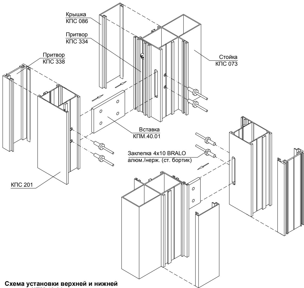
**Схема установки верхней и нижней вставки КПМ.40.01 для крепления притворной стойки КПС 201 (КПС 080)**
