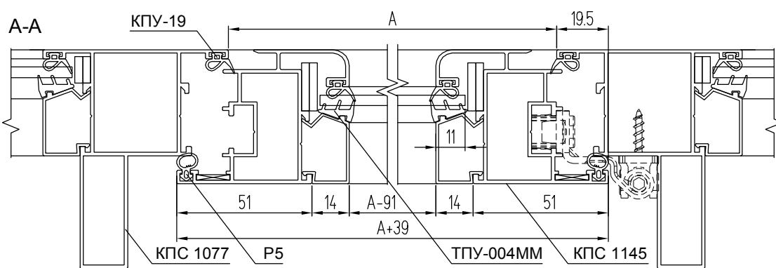
**Фрагмент балкона с одной распашной структурной створкой с открыванием внутрь на стойках с внутренним пилоном
