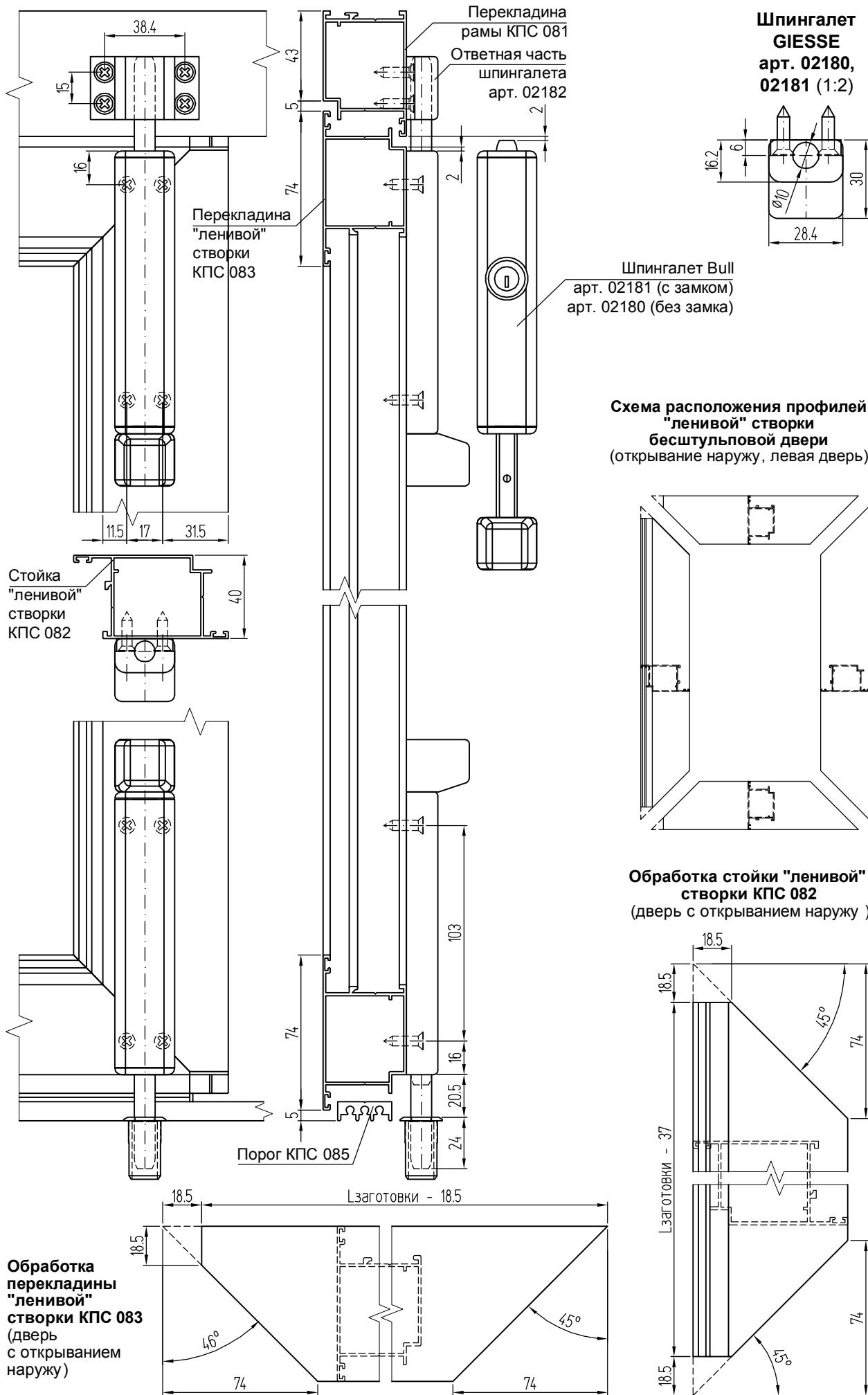
**Вариант сборки угла "ленивой" створки бесштульповой двухстворчатой двери с применением заглушек КПП-42, КПП-42-1 и закладных КПС 807-23**
