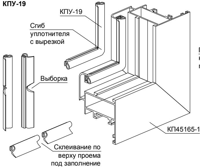
Вариант установки уплотнителей внешнего контура с разделкой горизонтальных и вертикальных деталей под углом 45°
