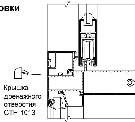
Выполнение дренажных отверстий в ригелях с внутренним пилоном под установку крышки дренажного отверстия СТН-1013
