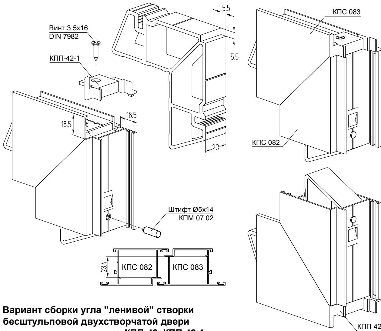
**Вариант сборки угла "ленивой" створки бесштульповой двухстворчатой двери с применением заглушек КПП-42, КПП-42-1 и закладных КПС 807-37/30**
