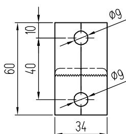
**Крепление стоек к плите перекрытия при помощи стального несущего кронштейна КСН-40-1 (на примере стойки КПС 1104)**
