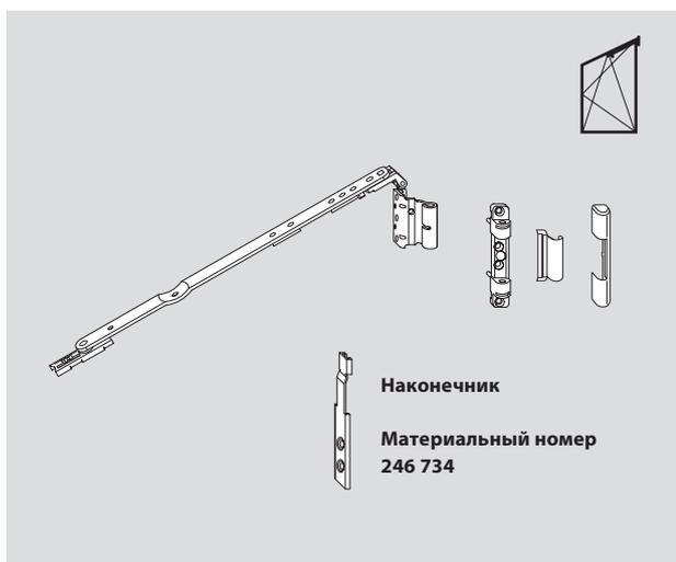
**Ножницы на раме К, система 12/18-9 для косоугольных окон, вес створки max. 80 кг**
